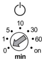
«on»: En cas d'absence, l'éclairage de veille (stand-by) est maintenu en permanence. En outre pour la régulation à lumière constante: Si le niveau d'éclairement de la pièce dépasse le seuil de consigne, la lumière s'éteint; dès qu'il descend à nouveau au-dessous du seuil de commutation, l'éclairage de veille (stand-by) est rétabli.
