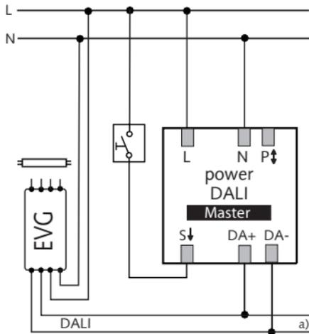
a) pour le raccordement de ballasts variables au protocole DALI
