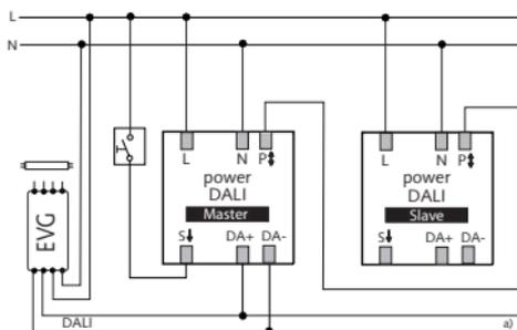
a) pour le raccordement de ballasts variables au protocole DALI
