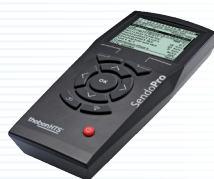
SendoPro 868-A Télécommande de service
