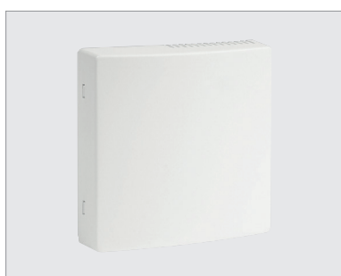
En option : STAD01-NTC10K , sonde de température ambiante avec capteur NTC 10 kΩ, IP30, L 85 × H 85 × P 31 mm
