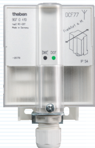
Antenne DCF 77, réf. 907 0 410; dimensions: 93 x 72 x 54 mm pour SELEKTA 171 top2 RC
